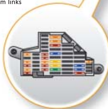
Sicherungsbox in der Schalttafel links
