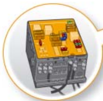
Vorsicherungsbox im Motorraum links
